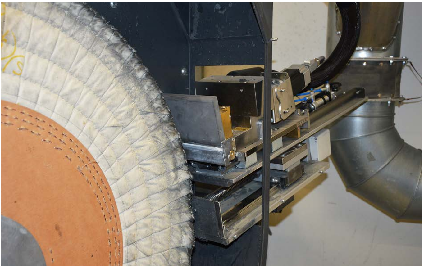
Abb. 3: Dosierkopf Integration an bestehender Polieranlage
