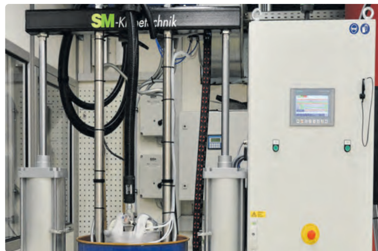
Pilotanlage für das neue Auftragsverfahren fester Polierpasten
