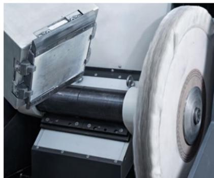
Unser Fingerprint-Verfahren entschlüsselt die Besonderheiten Ihres Polierprozesses und ermöglicht maximale Effizienz. Durch Inline-Messung ermitteln wir die einzelnen Effekte aller relevanten Parameter auf das Endergebnis: Werkstoff, Art und Menge des Poliermittels, Polierzeit, Anpressdruck und Art des Polierwerkzeugs. Aus den gewonnenen Prozessdaten leiten wir Empfehlungen für die Optimierung der Polierverfahren ab.
